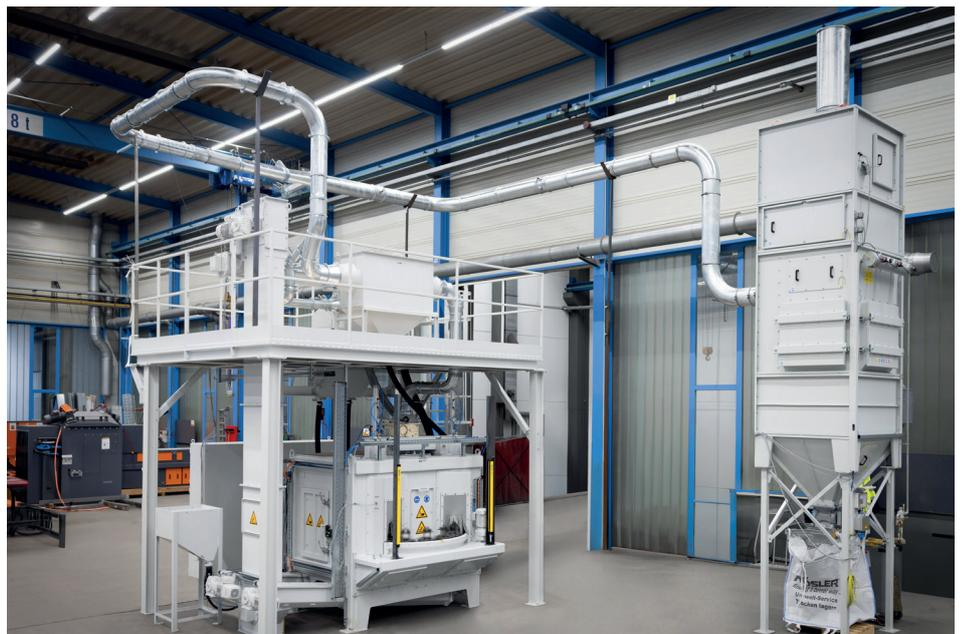
**Legenda:** A máquina de jato de mesa rotativa indexada com satélites RST 200-S15 foi projetada para jateamento de diferentes componentes de transmissão em curtos ciclos de tempo. A grande plataforma de inspeção e manutenção permite acesso rápido a todas as áreas críticas da máquina, como o sistema recuperação e de abrasivo, bem como ao painel de controle.
