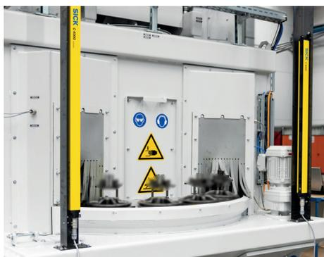
**Legenda:** A mesa rotativa contém 15 estações (satélites rotativos) equipadas com dispositivos de fixação específicos para cada peça. Um sistema especial de manuseio automático de peças, fornecido pelo cliente, coloca e remove as peças para dentro e para fora das estações. O transporte das peças ocorre em ciclos de indexação de 20 segundos.
